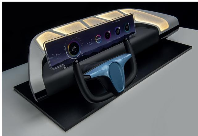
**Bild 1.** Das Direct-Coating eignet sich sowohl für Bauteile im Innenraum als auch im Exterieur von Fahrzeugen. Es ermöglicht die Integration von Elementen und Sensoren und gleichzeitig die Herstellung von hochwertigen Oberflächen
