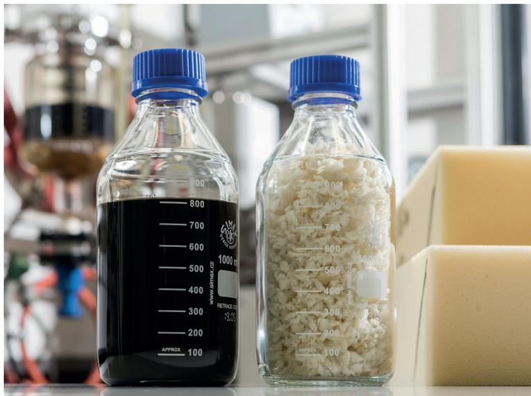
**Bild 5.** Das von BASF entwickelte Verfahren kann Weichschaummatratzen zu Polyolen verarbeiten, die sich erneut für die PUR-Herstellung nutzen lassen
